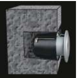
Installation with clips embedded into sleeve,fix on the concrete wall 使用嵌入的夹子安装套筒，固定在混凝土墙上。
